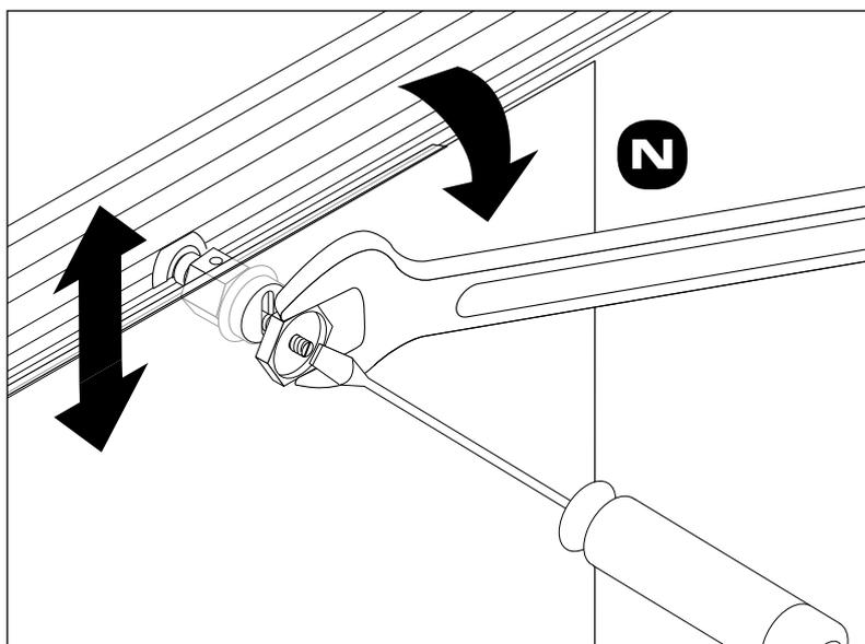
**N** - Fermez les deux portes (contact du joint magnétique). positionnez-les d'aplomb à l'aide d'un niveau à bulle. Bloquez les roulettes hautes à l'aide d'un tournevis plat et d'une clef plate. (Le tournevis doit maintenir l'axe de la roulette)
