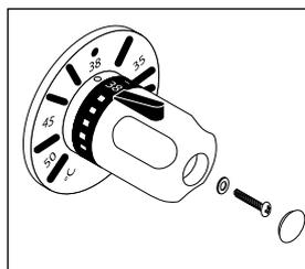
Dans le cas contraire, ôtez le cache-vis chromé situé à l'extrémité du bouton, à l'aide d'un tournevis. Dévissez la vis centrale. Retirez le bouton ainsi que la bague noire graduée.
