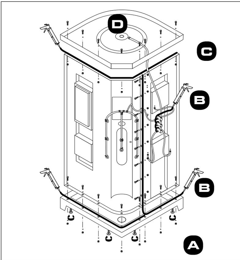
**A** - Après avoir déterminé l'emplacement de votre cabine intégrale, positionnez le receveur et au besoin réglez l'aplomb à l'aide des vérins réglables. Retirez les films de protection sur le receveur et les fonds thermoformés.
