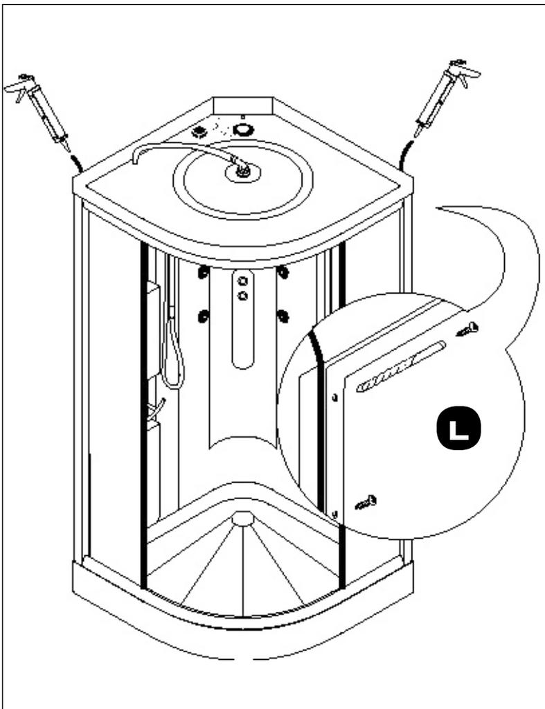
**L** - Positionnez l'ensemble sur le receveur. Percez les montants au travers des trous situés dans les fonds, puis vissez-les, après avoir déposé un cordon de silicone entre les deux. Faites attention à ce que les fonds thermoformés soient bien d'aplomb.
