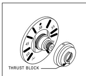
Retirez la bague plastique et repositionnez là comme sur le schéma ci-contre. La butée doit être positionnée sur la gauche.
