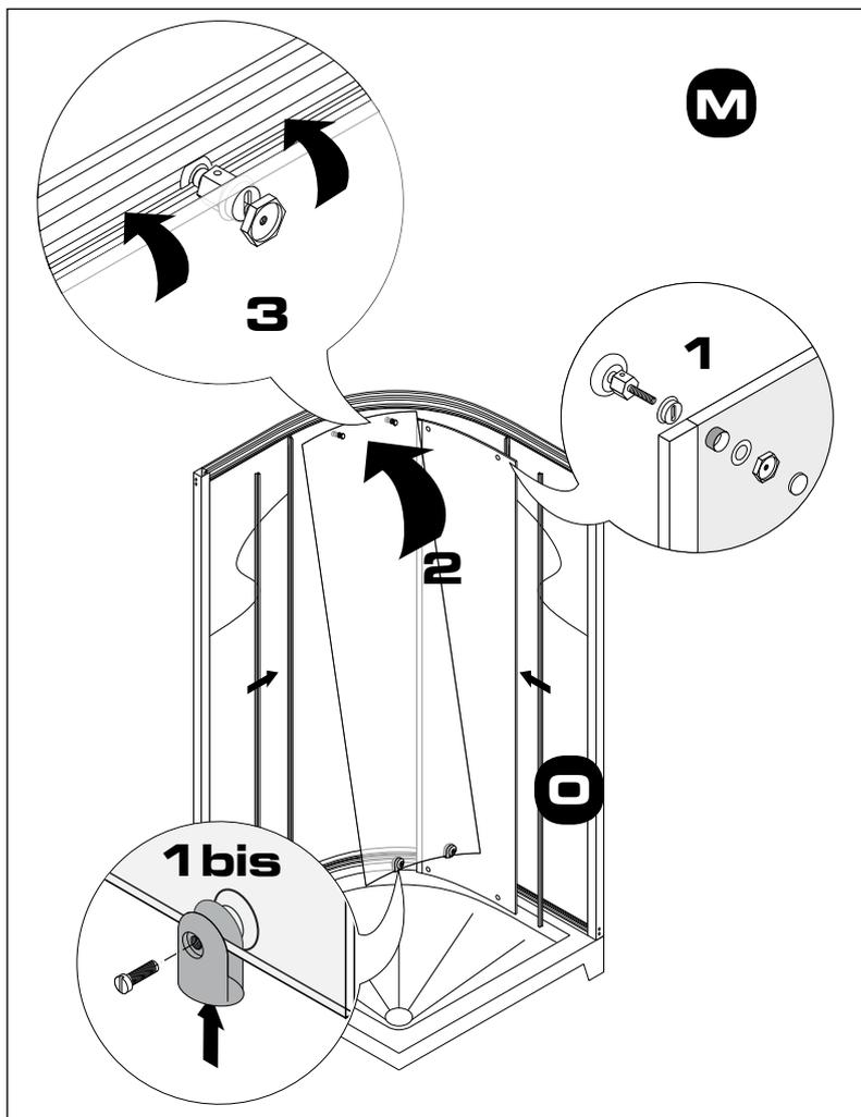
**M - 1** / Assemblez sans serrer les roulettes supérieures sur les 2 portes coulissantes. Attention, les roulettes sont montées sur un axe à rotule pour obtenir un guidage parfait dans les courbes, il est important de respecter l'orientation des pièces, comme représenté dans la bulle (de façon à ce que la roulette pivote sur l'axe horizontal).
