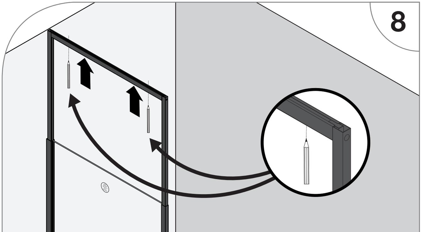
Etirez l'encadrement supérieur jusqu'au plafond et repérez les 2 perçages.
