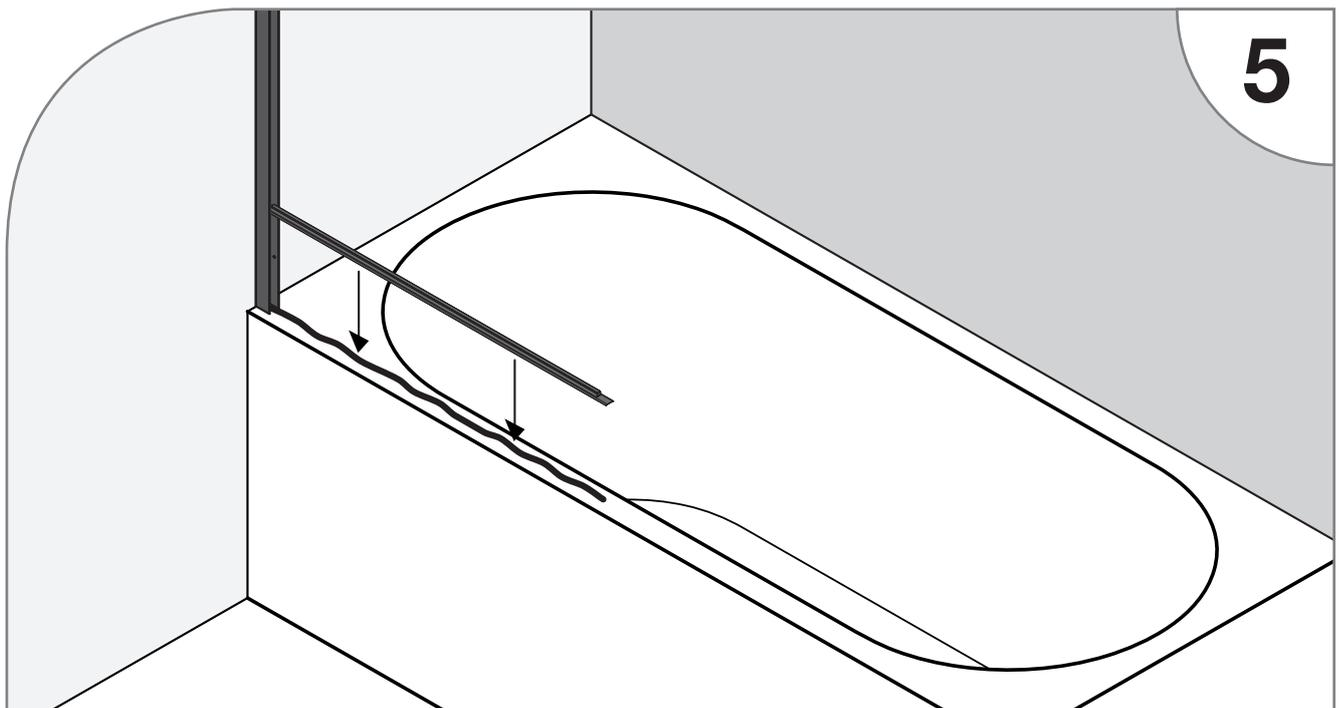
Sans attendre, placez la baguette d'étanchéité sur le cordon de silicone.
