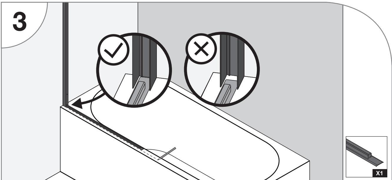
Positionnez la baguette d'étanchéité sur votre baignoire en contrôlant les points suivants :
