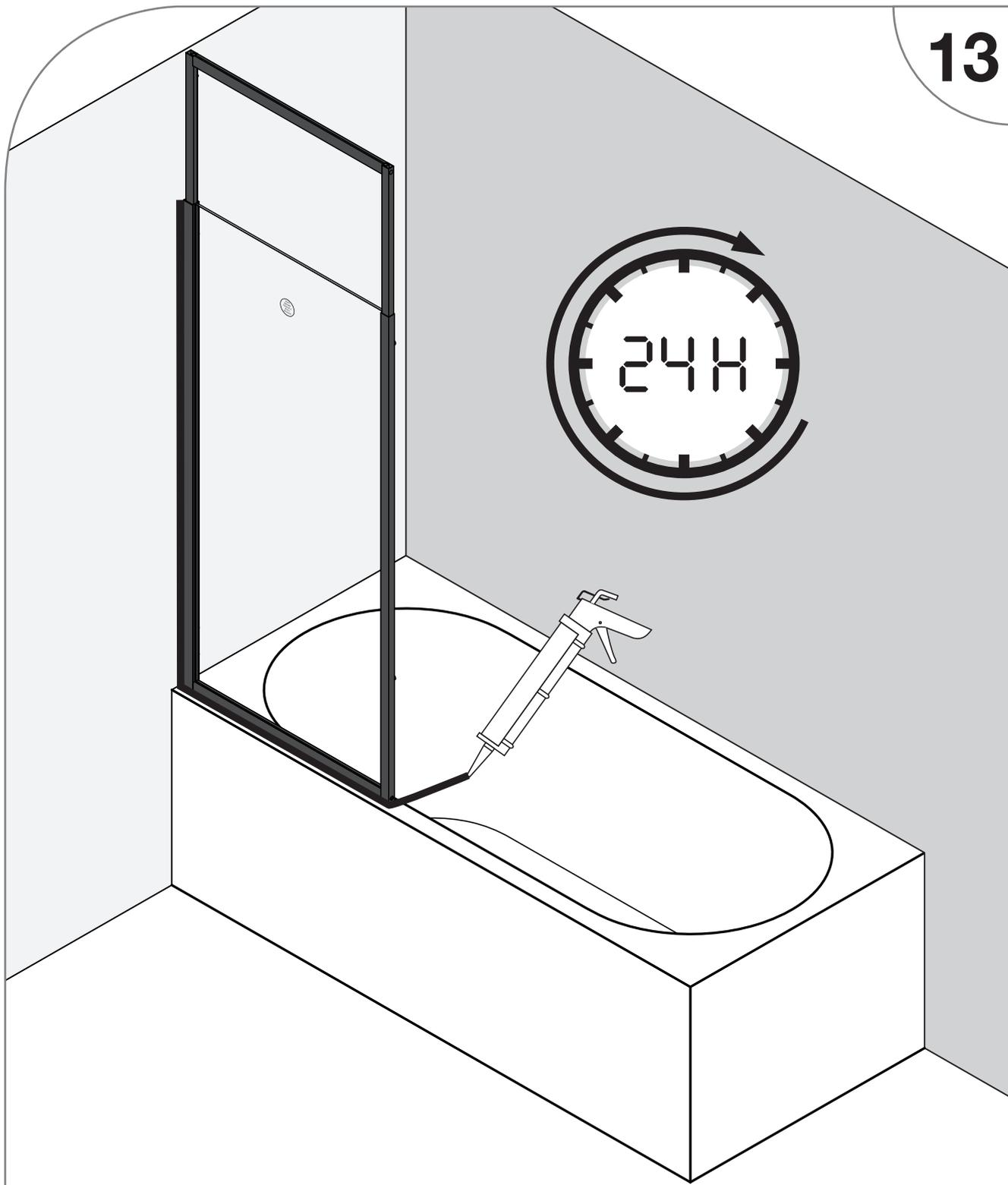
Afin d'assurer une étanchéité totale, nous conseillons de siliconer la jonction extérieure entre le mur, la baignoire et les profilés. Utiliser du silicone sanitaire bactéricide et fongicide afin de garantir sa tenue dans le temps.
