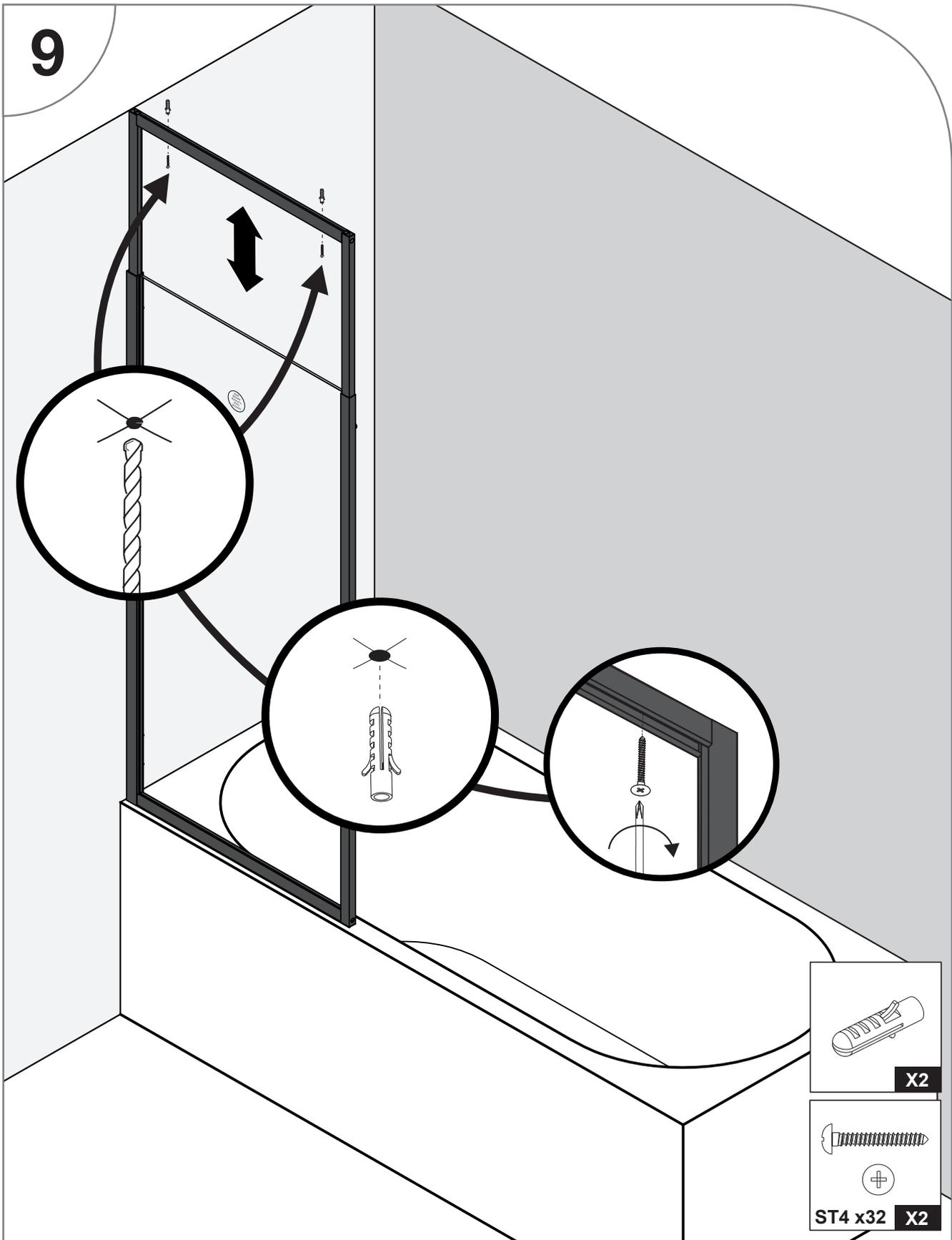
Rabaissez l'encadrement supérieur en position initiale avant de percer.
