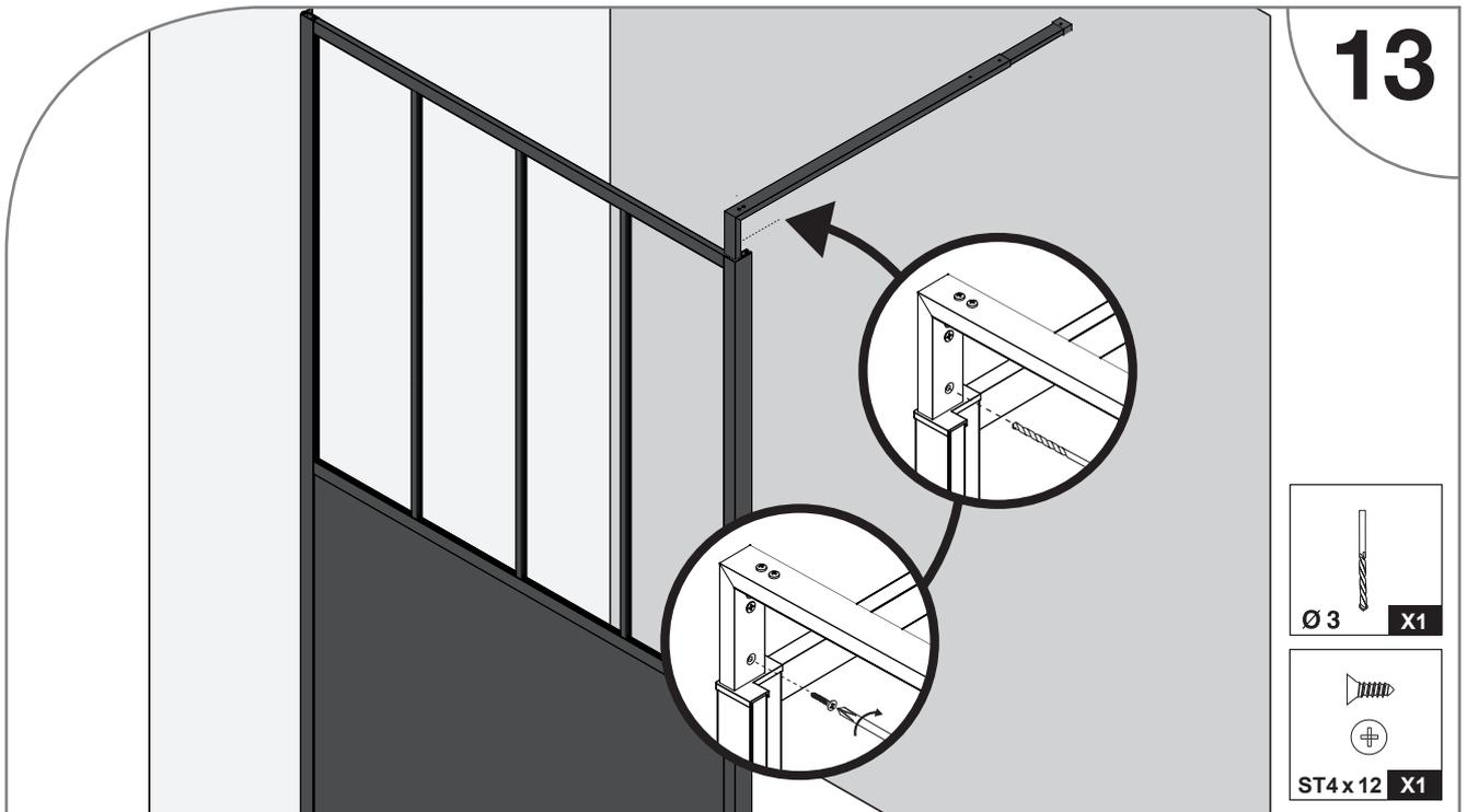
Fixez le barre de renfort sur le raccord d'angle à l'aide du forêt et la vis fournis.
