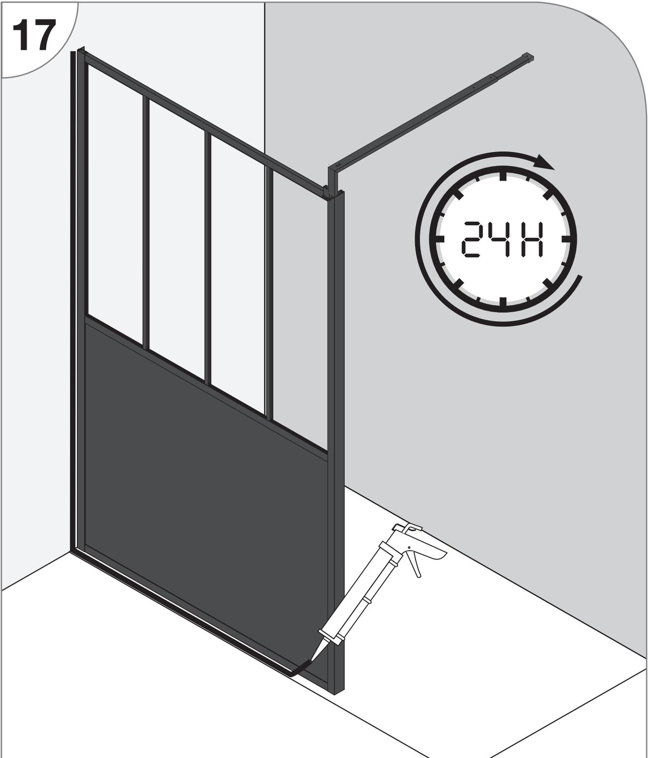
Afin d'assurer une étanchéité totale, nous conseillons de siliconer les jonctions extérieures avec le mur et le sol. Utiliser du silicone sanitaire bactéricide et fongicide afin de garantir sa tenue dans le temps. Respecter le temps de séchage recommandé avant la mise en eau.
