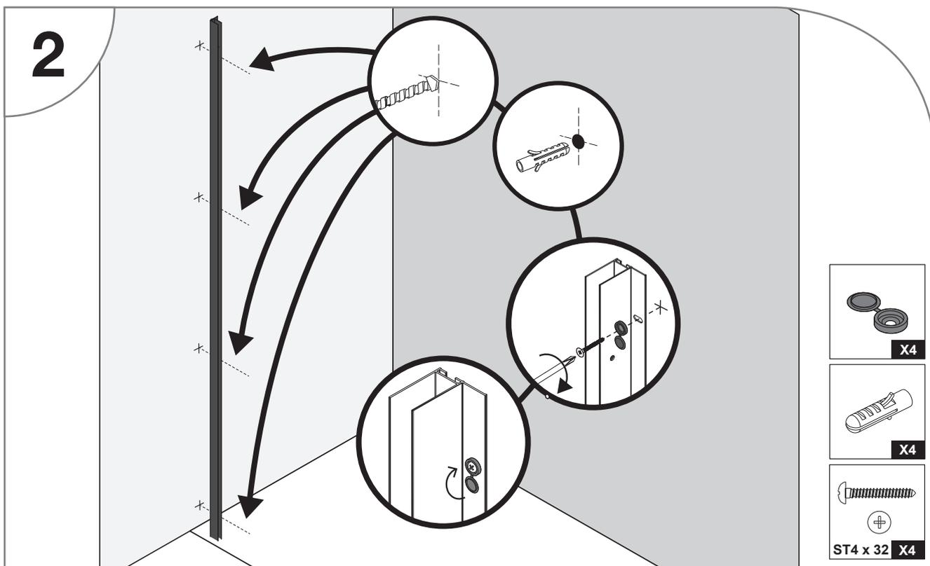
Percez les trous à l'aide d'un forêt adapté à votre mur (non-fourri). Fixez le profilé au mur à l'aide de chevilles et de vis adaptées à votre mur. Sans oublier d'intercaler les cache-vis.
