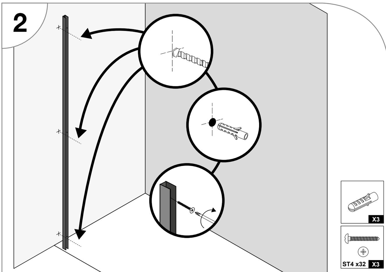
Percez les trous à l'aide d'un forêt adapté à votre mur (non-fourni). Fixez le profilé au mur à l'aide de chevilles et de vis adaptées à votre mur.
