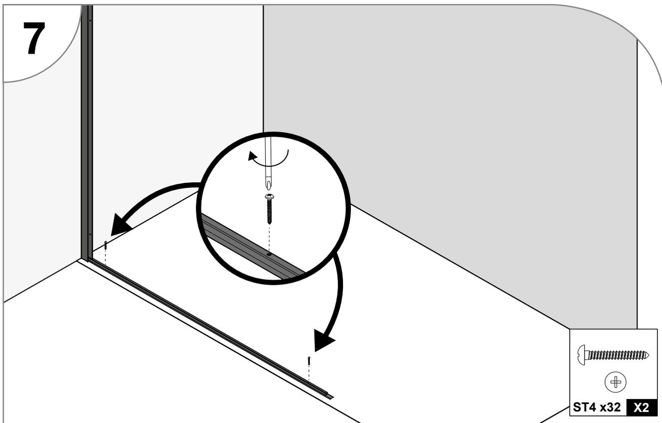
Vissez la baguette d'étanchéité au sol en veillant à ne pas la déformer.
