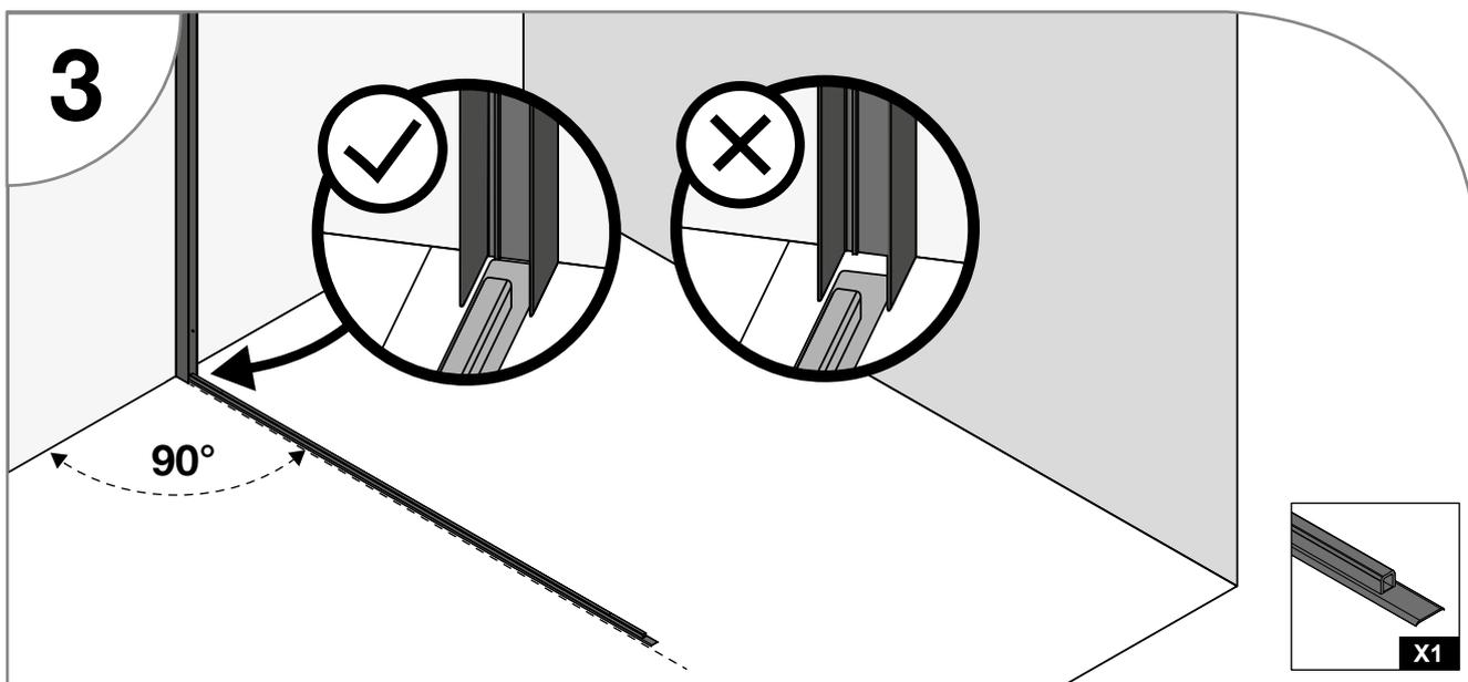
Positionnez la baguette d'étanchéité sur votre sol en contrôlant les points suivants :
