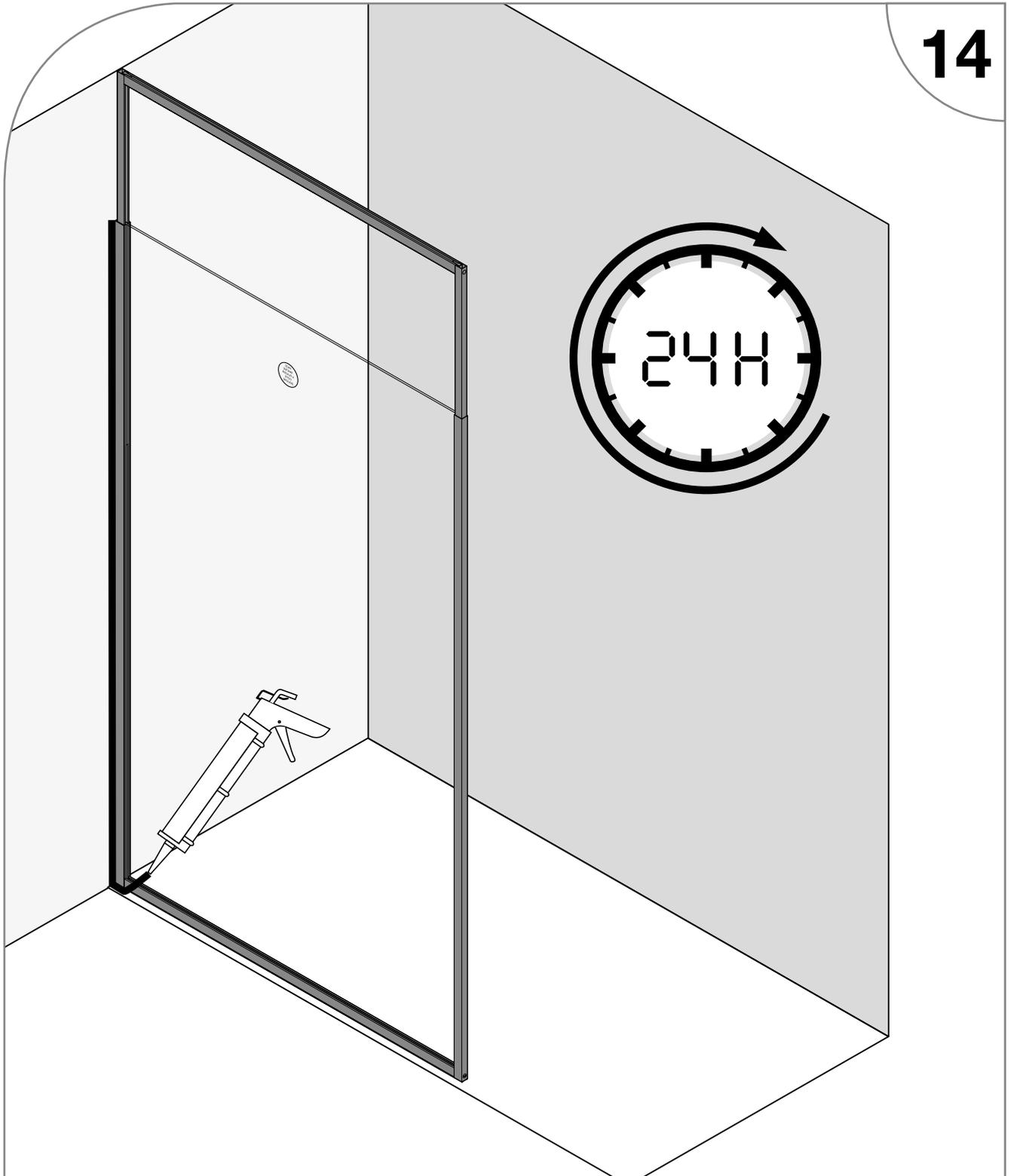
Afin d'assurer une étanchéité totale, nous conseillons de siliconer la jonction extérieure entre le mur et le profilé sur toute sa hauteur. Utiliser du silicone sanitaire bactéricide et fongicide afin de garantir sa tenue dans le temps.
