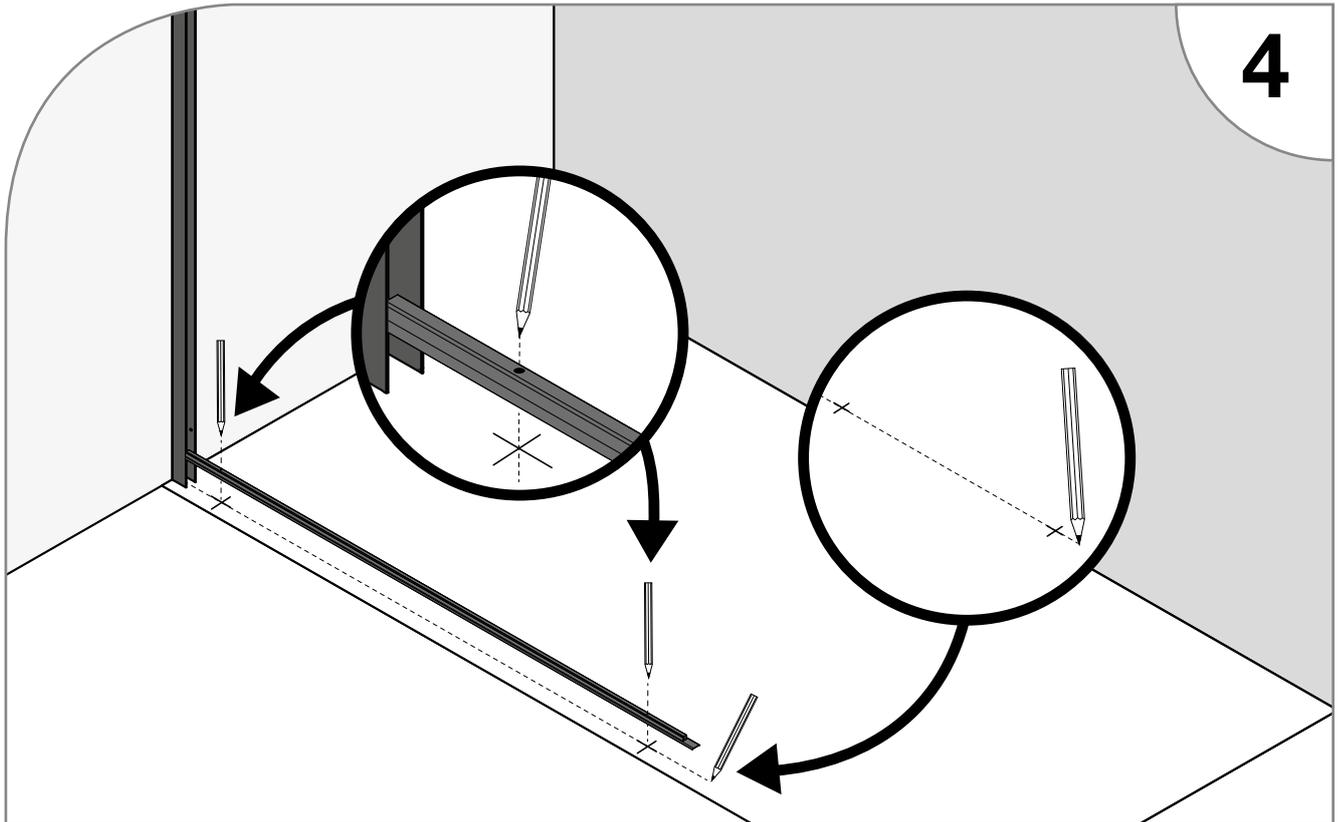
Une fois la baguette bien positionnée. Repérez les trous de perçages sur le sol et tracez une ligne qui relie ces deux points.
