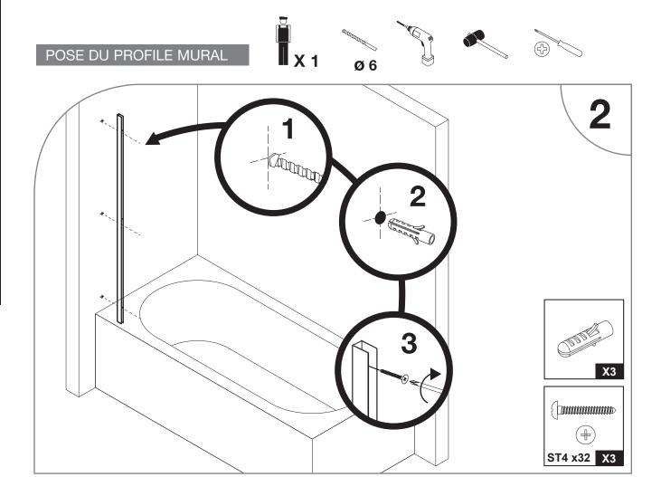
Perçez les trous à l'aide d'un forêt adapté à votre mur ( non-fourni ). Fixez le profilé au mur à l'aide de chevilles et de vis adaptées.
