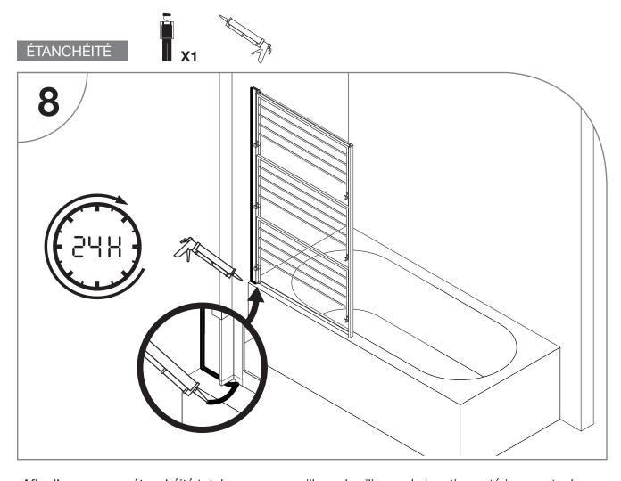
Afin d'assurer une étanchéité totale, nous conseillons de siliconer la jonction extérieure entre le mur et le profilé sur toute sa hauteur. Utilisez du silicone sanitaire bactéricide et fongicide afin de garantir sa tenue dans le temps.
