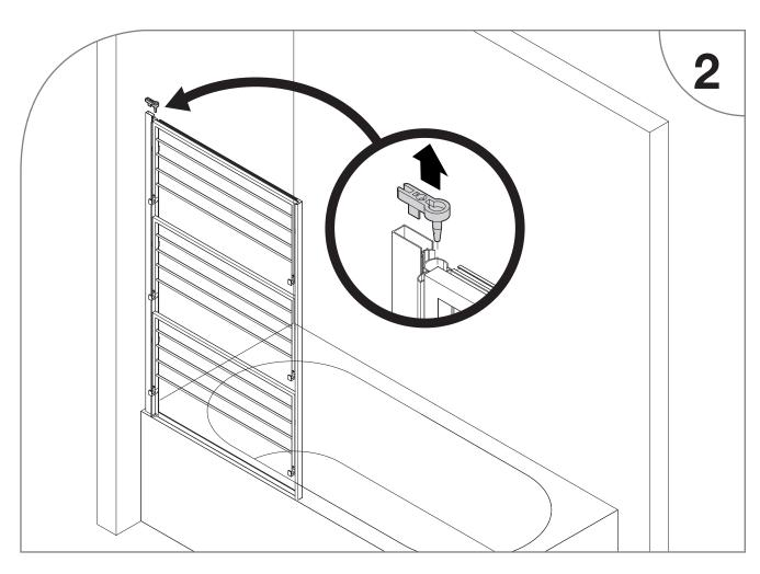
Cette étape doit impérativement être réalisée à deux. Pendant qu'une personne tient le pare-baignoire en position, la seconde doit démonter le pivot plastique en prenant soin de ne pas casser l'axe.
