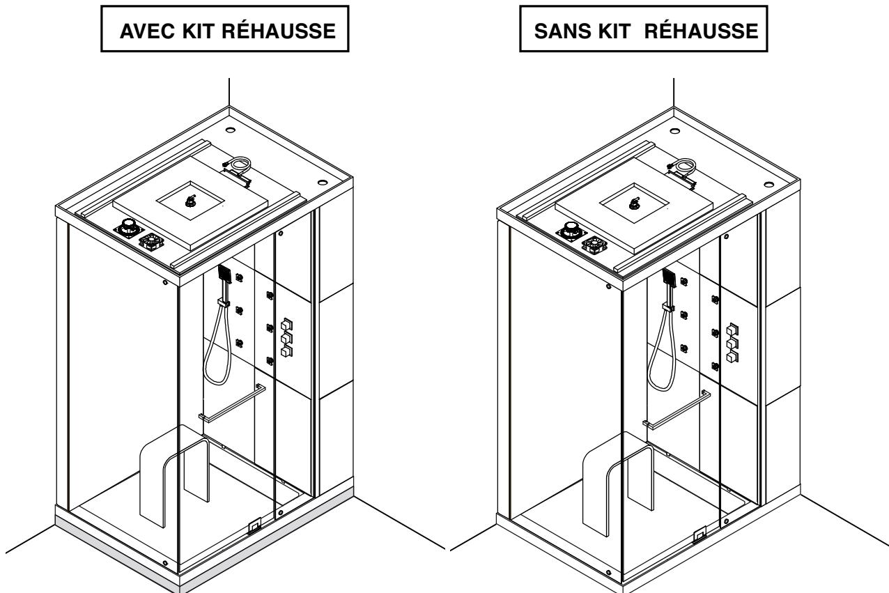
Vous avez la possibilité de réaliser un montage sans réhausse («jupe» fournie systématiquement). Dans ce cas, assurez-vous d'avoir un sol préparé, adapté à la pose de votre receveur et une évacuation optimale. Ce type de pose est plus difficile à mettre en oeuvre, ne vous lancez pas dans ce type de pose sans vous être préalablement assuré de remplir les conditions ci-dessous.
